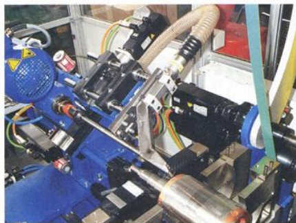
Bild 3: Mit einer extrem langen Werkzeughalterverlängerung wird die schwer zugängliche Wuchtbohrung eingebracht.
