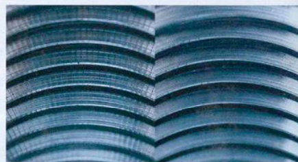
Bild 5: Dank Schwingungsdämpfung lassen sich mit dem Hydro-Dehnspannfutter sichtbar brillantere Oberflächen erzielen (Werkbilder: Schunk GmbH & Co. KG, Lauffen/Neckar)
