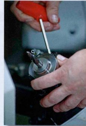
Bild 2: Der Werkzeugwechsel erfolgt bei dem Hydro-Dehnspannfutter schnell und präzise. Ein Sechskantschlüssel genügt
