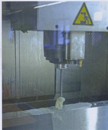
Dank kühlmitteldichter Zwischenbüchsen ist das Spannfutter für Werkzeuge mit innerer Kühlmittelzufuhr geeignet
