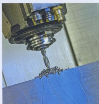
Das Hydro-Dehnspannfutter ist hochpräzise und dämpft auftretende Schwingungen
