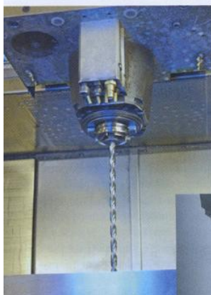
Tendo-ES löst Probleme, wenn beim Tiefbohren der Maschinenraum zu klein wird
