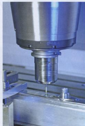
3 Mit einem 0,8-mm-Mikroschaftfräser wurden in die Prototypen eines Nachspülarms exakt definierte Schlitzte gefräst, um das Spülergebnis möglichst optimal zu gestalten
