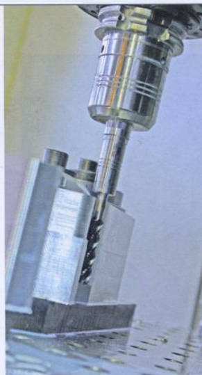
3 Die Kombination aus Sino-Universalspannfutter und Tribos-Verlängerung wird beim Institut Dr. Foerster zum Problemlöser: Mit einem 10-mm-Bohrschruppfräser lassen sich bei 1500 min -1 und 100 bis 200 mm Vorschub selbst schwierigste Werkstückgeometrien vorschruppen
