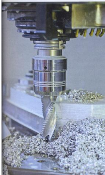
2 Mit dem »Sino-R« werden bei einem 32-mm-Durchmesser Drehmomente bis 850 Nm souverän übertragen
