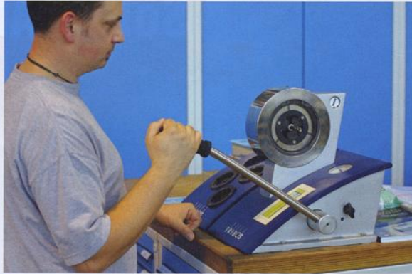
4 Sven Ferrelli: »Neben der hohen Rundlauf- und Wechselwiederholgenauigkeit sowie der Wartungsfreiheit haben die Tribos-Verlängerungen einen weiteren Vorteil, sie lassen sich einfach und schnell spannen«
