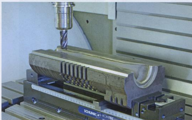
Das Fräsen der Planfläche, die die Schnittstelle zwischen den beiden Formhälften bildet, ist einer der sensibelsten Fertigungsschritte. Sino ermöglicht dabei nach Erfahrung von Schunk eine wirtschaftliche Schwerzerspannung und sorgt für perfekte Oberflächen.
