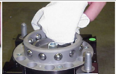
Reinigung von Verriegelungskugeln, Kolben und Innenseite des Verriegelungsmechanismus
