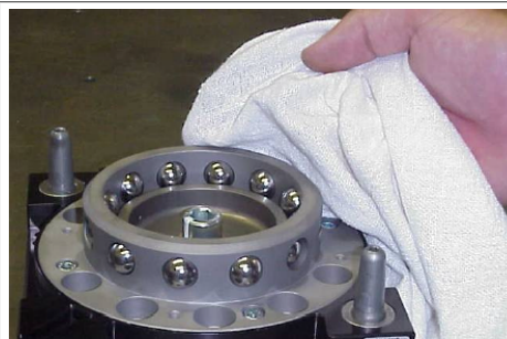
Reinigung von Verriegelungskugeln und Außenseite des Verriegelungsmechanismus
