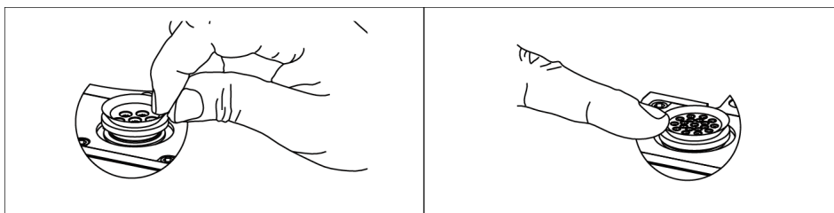
Dichtung des elektrischen Durchführungsmoduls entnehmen und einsetzen
